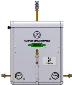
Sistema de 3 reguladores de presión (2 para alta presión y 1 para baja presión) con "By-Pass" de válvulas de esfera fabricadas en acero inoxidable, válvulas de sobrepresión y válvulas de alivio interconectadas para salida al exterior.
